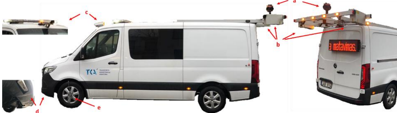
1 pav. Specialus automobilis su sumontuota kelio dangos kokybės tyrimo įranga
