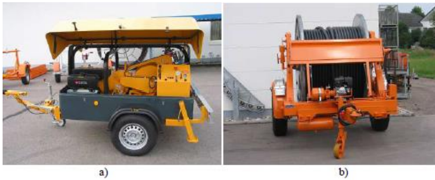
4 pav. Kabelio tempimo jėgą ir pakloto kabelio ilgį fiksuojanti kabelių tempimo mašina (a) ir kabelio transportavimo vežimėlis (b)
