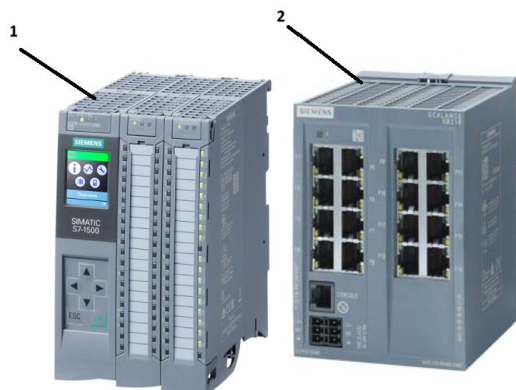
5 pav. PLC su papildomu moduliu. 1 - Siemens SIMATIC S7-1500 programuojamas loginis valdiklis, 2 – papildomas Ethernet jungčių modulis Siemens Scalance XB216 [17]
