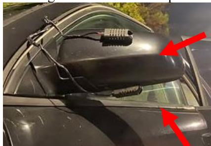
2 pav. Temperatūros ir drėgmės DHT21 jutiklių montavimo vietos veidrodėlio korpuso: 1 – apačioje, 2 – priekyje (prieš vėją)
