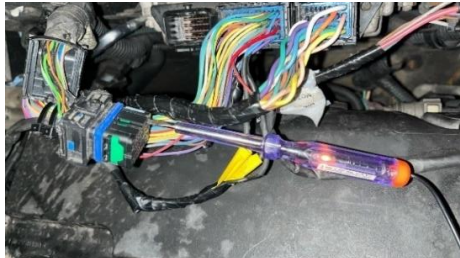
4 pav. EDC16C34 maitinimo kontaktų tikrinimas testavimo lempute Šaltinis: nuotrauka autorių
