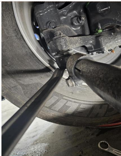
1 pav. Krovininio automobilio Scania P450 skersinės traukės vertinimas Šaltinis: sudaryta autorių
