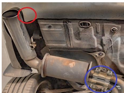
1 pav. Automobilio išmetimo sistemos garso reguliavimo sklendės įrengimo vieta (jutiklio įrengimo vieta pažymėta raudona, o sklendės vieta pažymėta mėlynai)
