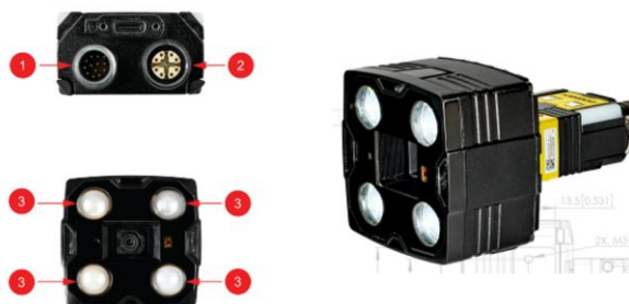
7 pav. Cognex In-Sight 2802 : 1,2 – išsišakojimo kabelio ir, atitinkamai, Ethernet jungtis, 3 – LED apšvietimas [18]
