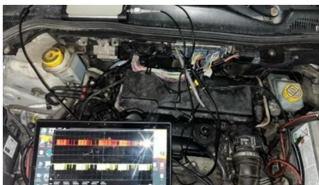
5 pav. Variklio valdymo bloko CAN signalų patikra Šaltinis: nuotrauka autorių
