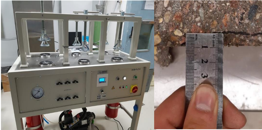
2 pav. Vandens įsikverbimo į betoną bandymo stendas ir vandens prasiskverbimo gylio nustatymas.
