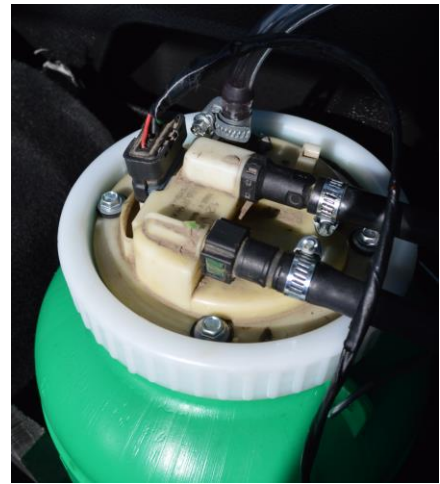
2 pav. Siurblys sumontuotas į bako dangtį Šaltinis: sudaryta autoriaus
