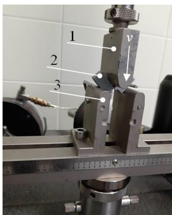
3 pav. Bandinių universaliame stende Instron 5960 vaizdas: 1 – lenkimo prizmė, 2 – bandinys, 3 – atramos
