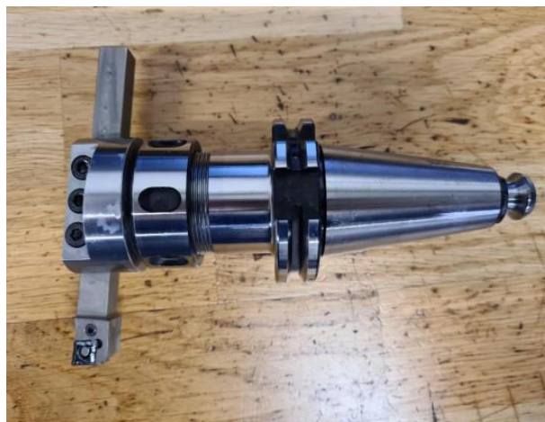
1 pav. Vienašmenis frezavimo įrankis su laikikliu Šaltinis: sudaryta autorių
