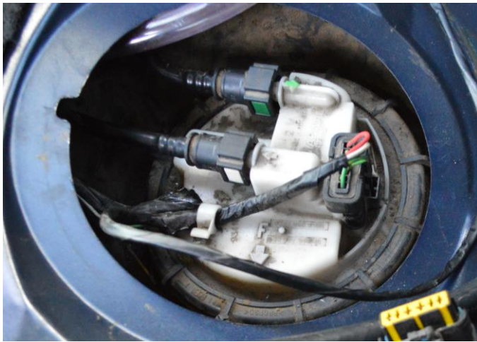
1 pav. Automobilio bako degalų siurblys Šaltinis: sudaryta autoriaus
