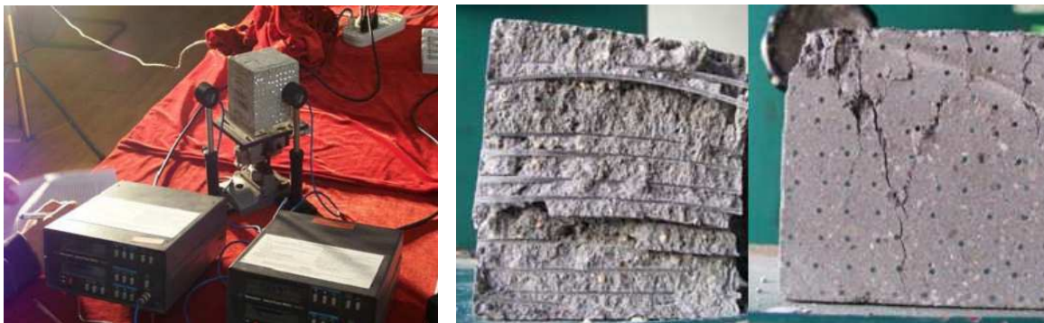
5 pav. Šviesai pralaidaus betono šviesos srauto ir stiprio gniuždant bandymai
