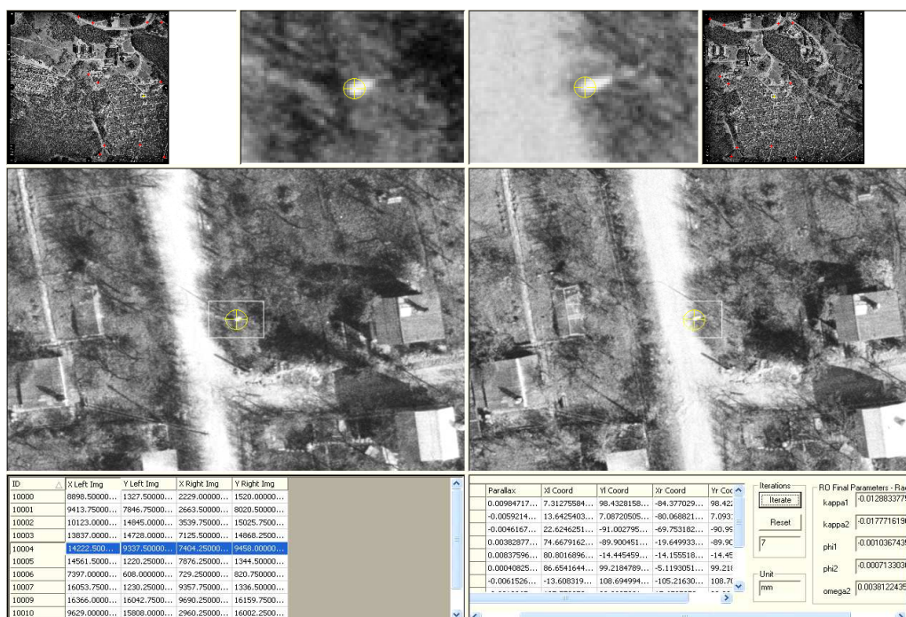
5 pav. Aerofotonuotraukų tarpusavio orientavimo rezultatai Šaltinis: sudaryta autorių
