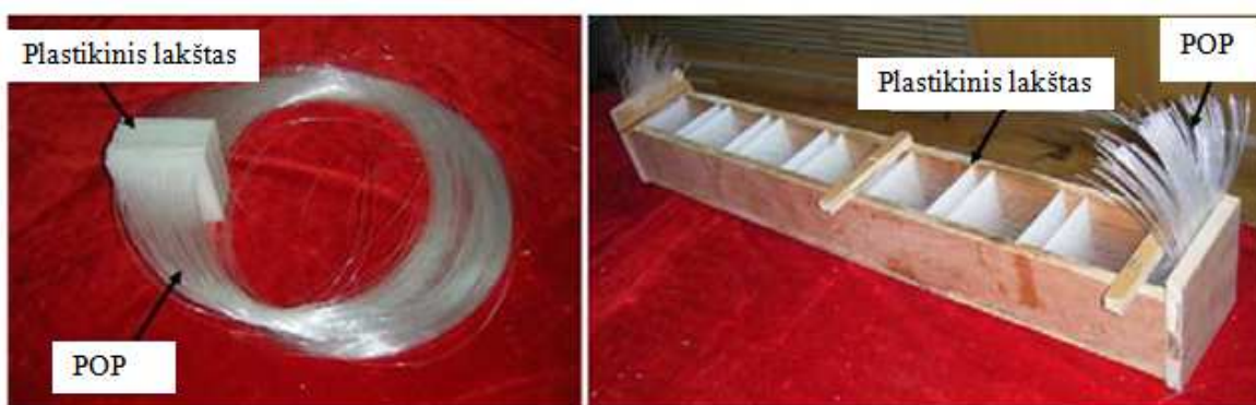
3 pav. Plastikinio optinio pluošto (POP) išdėstymas klojinyje
