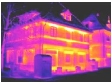
2 pav. Fasado šiluminės izoliacijos tyrimui Šaltinis: Elintos matavimo sistemos
