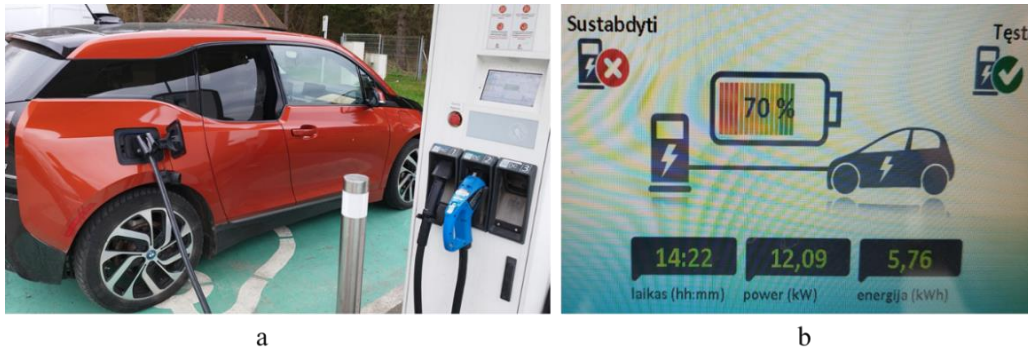
2 pav. BMW i3 įkrovimas: a – automobilis įkraunamas DC srove; b – greitojo įkrovimo stotelės QC45 ekranas įkrovimo metu Šaltinis: sudaryta autorių
