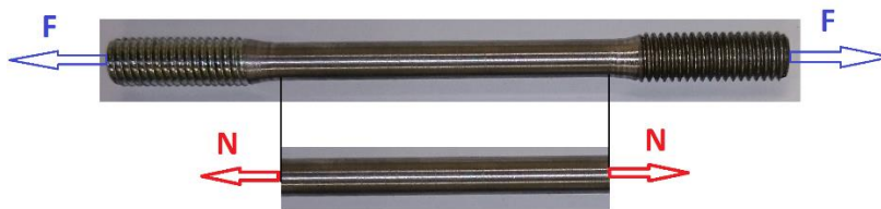
1 Pav. Strypo įtvirtinimo galai ir ašinė jėga N Šaltinis: sudaryta autorių
