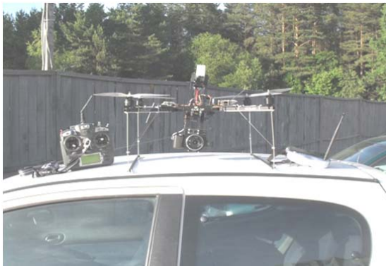
2 pav. Bepilotis skraidymo aparatas ir fotogrametrinių duomenų gavimas: a) UAV su integruotu davikliu ir nuotoliniu būdu valdomas įtaisas; b) vietovės fotografavimas
