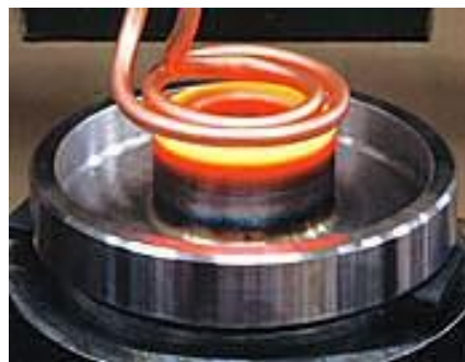
2 pav. Plokščio paviršiaus kaitinimas
