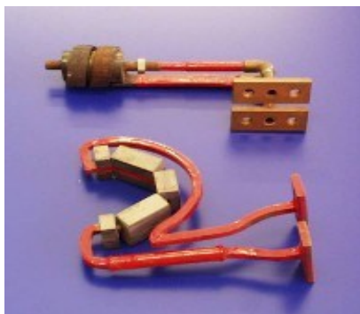
3 pav. Induktoriai vidinių paviršių kaitinimui
