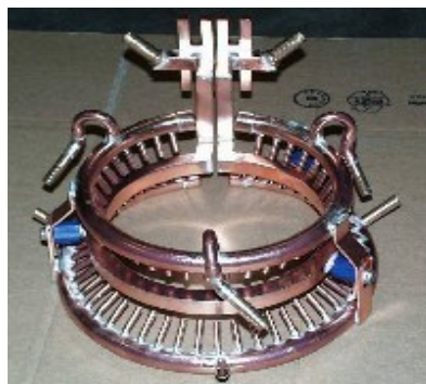
4 pav. Induktorius sudėtingos formos paviršiaus kaitinimui
