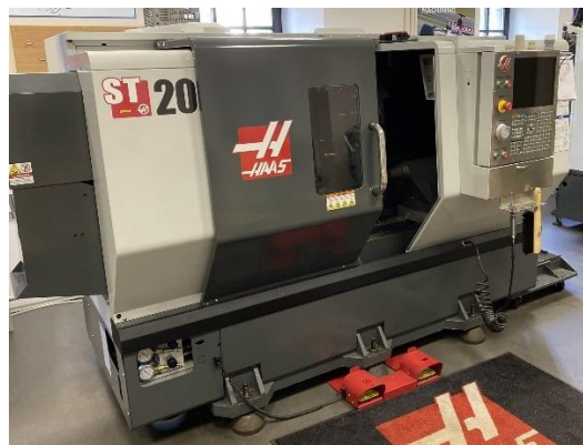
1 pav. Įprastinės tekinimo staklės 16K20 (kairėje) ir HAAS Automation Inc. firmos CNC tekinimo centras ST-20 (dešinėje)
