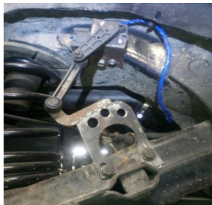
2 pav. SAAB automobilyje sumontuotas pakabos aukščio jutiklis
