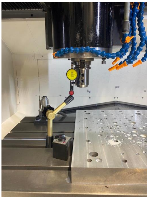
2 pav. Suklio galo padėties matavimo schema
