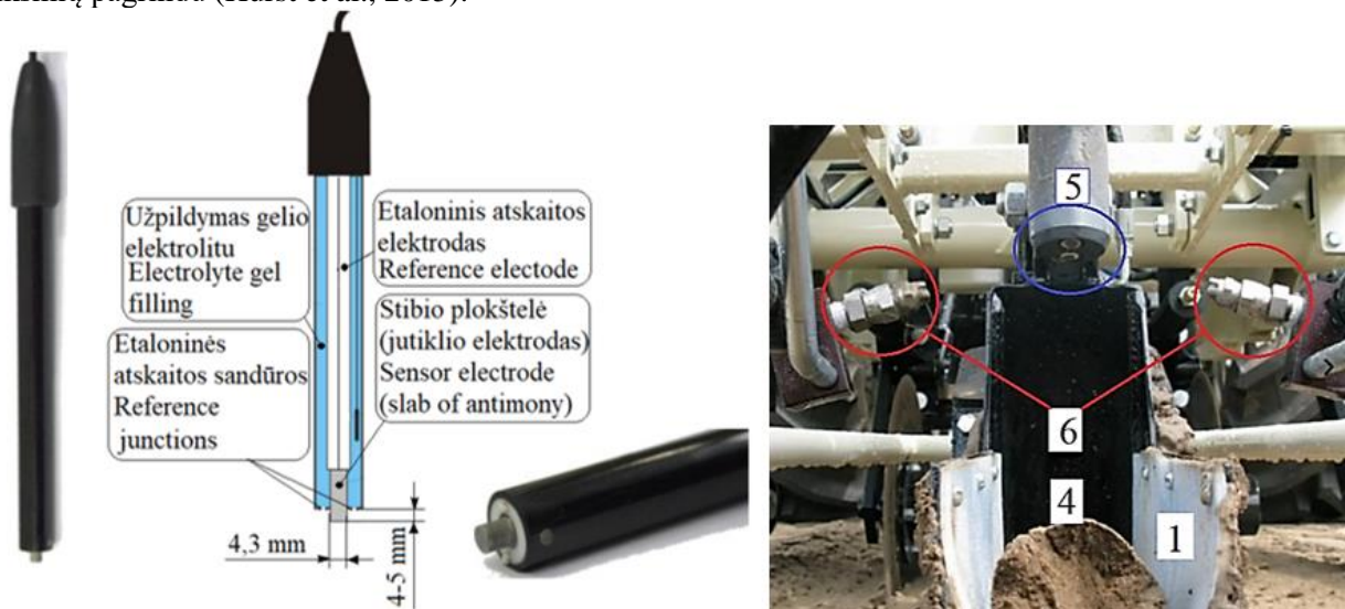
4 pav. Stibio elektrodas – jutiklis, kurio ilgis 120 mm, skersmuo 12 mm: 1 – lovelis; 4 – grandiklis; 5 – pH stibio elektrodai-jutikliai; 6 - elektrodų plovimo purkštukai
