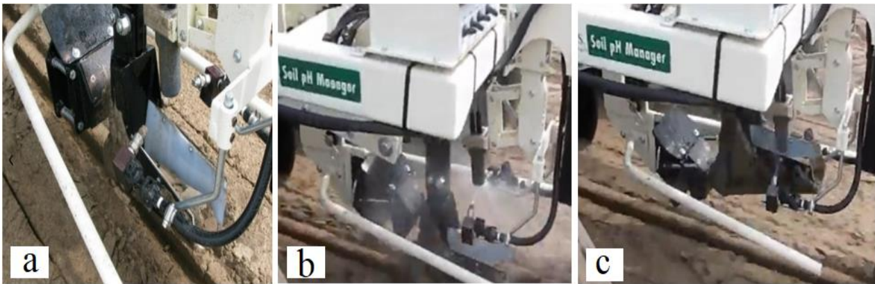
3 pav. Automatinio dirvos pH matavimo proceso eiliškumas: a – dirvos mėginio paėmimas; b – pH elektrodų nuplovimas; c – dirvos pH matavimas jonams selektyviųjų elektrodų deriniu Šaltinis: Veris Technologies. Prieiga per internetą: < https://veristech.com/soil-scanning-carts/ >
