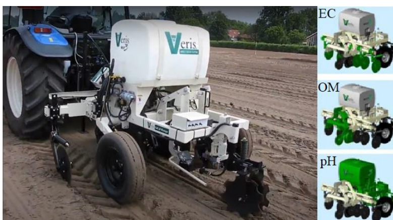
1 pav. Mobilus dirvos analizės įrenginys Veris MSP3, matuojantis atskirus dirvožemio komponentus: elektrinį laidumą (ECa); organines medžiagas (OM), dirvožemio rūgštingumą (pH)
